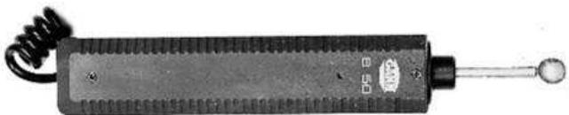
Aktive Sonde mit integrierter Elektronik zum zerstörungsfreien Aufspüren von Feuchtigkeit in Bauteilen aller Art sowie zur Erkennung der Feuchtigkeitsverteilung in Wänden, Decken und Fußböden. Die nach einem patentierten Messverfahren arbeitende Elektrode erzeugt ein konzentriertes Hochfrequenzfeld mit einer Tiefenwirkung bis zu 120 mm. Die Eindringtiefe ist von der jeweiligen Rohdichte des zu messenden Materials abhängig.
