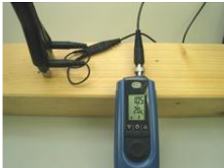
Abbildung 4-3 Messung quer zur Faserrichtung mit M 20
