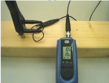
Abbildung 4-1 Messung quer zur Faserrichtung mit M 20
